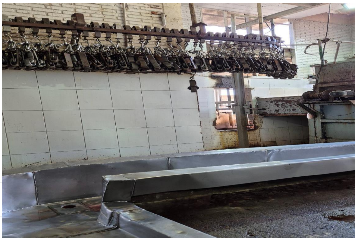
Foto 30: Sala de abate equipada (Canaleta de sangria, carretilhas, box de insensibilização, etc)
