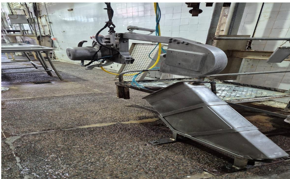
Foto 28: Sala de abate equipada (serra de carcaça, esterilizador e plataforma móvel, etc.)
