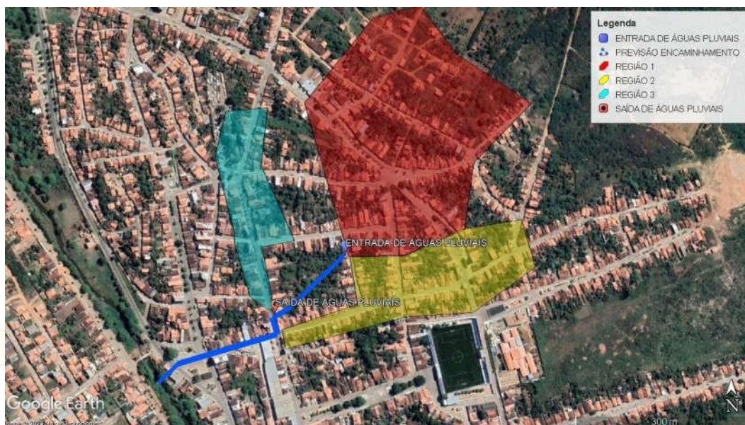
Foto 1 - Regiões que afetam ponto para intervenções e encaminhamento de águas pluviais.
