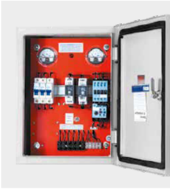
CPD T2: Armário de aço, disjuntores, contator, relé de sobrecarga, chave (A-M), bornes para boia, amperímetro, voltímetro, sinaleiro, relé falta de fase, relé de nível, eletrodos e para-raios.
