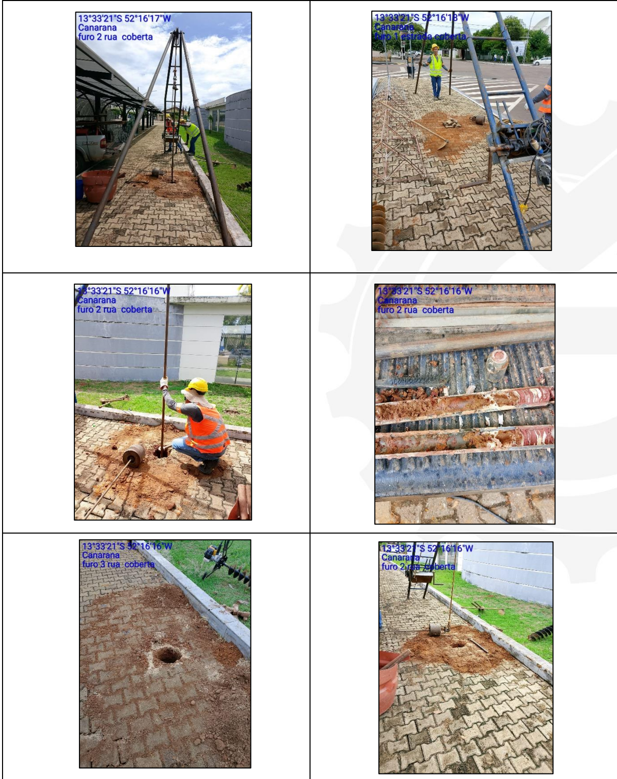
Relatório fotográfico da equipe em campo realizando sondagem e coleta de amostras.
