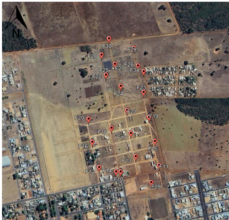
Plano de sondagem do subleito
