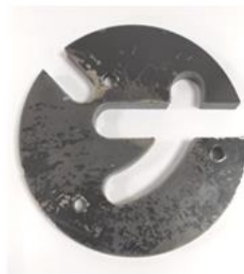
Figura 3. Peça da articulação do assento produzida em chapa de ferro.
