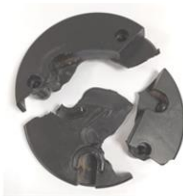
Figura 2. Peça danificada da articulação do assento produzida em termoplástico ABS.
