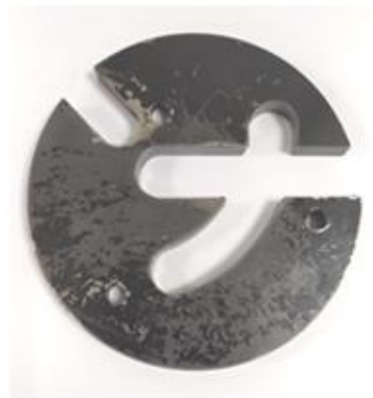
Figura 3. Peça da articulação do assento produzida em chapa de ferro.
