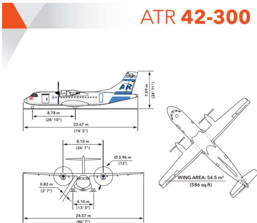
Figura 1 – Aeronave crítica – ATR 42-300
