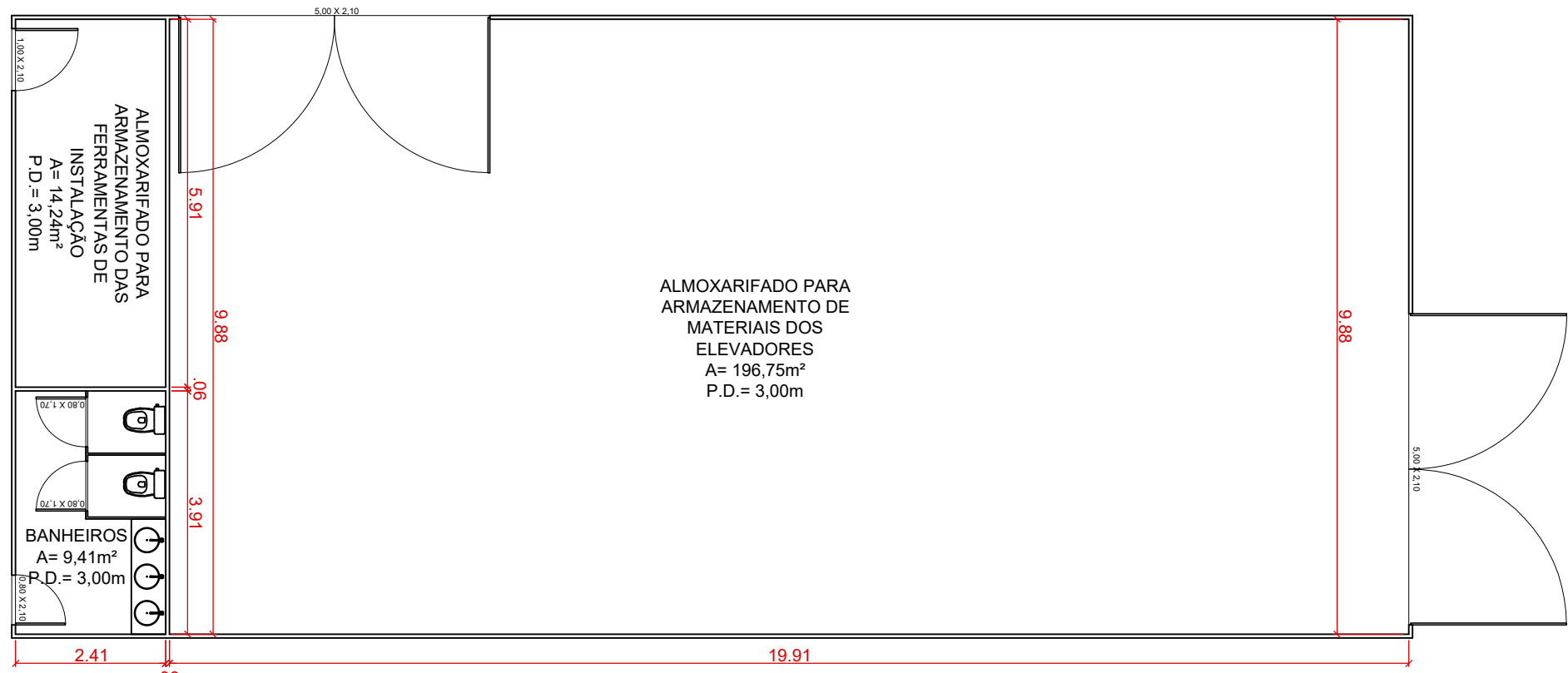
PLANTA - CANTEIRO DE OBRAS/ ALMOXARIFADO ESC. 1:100
