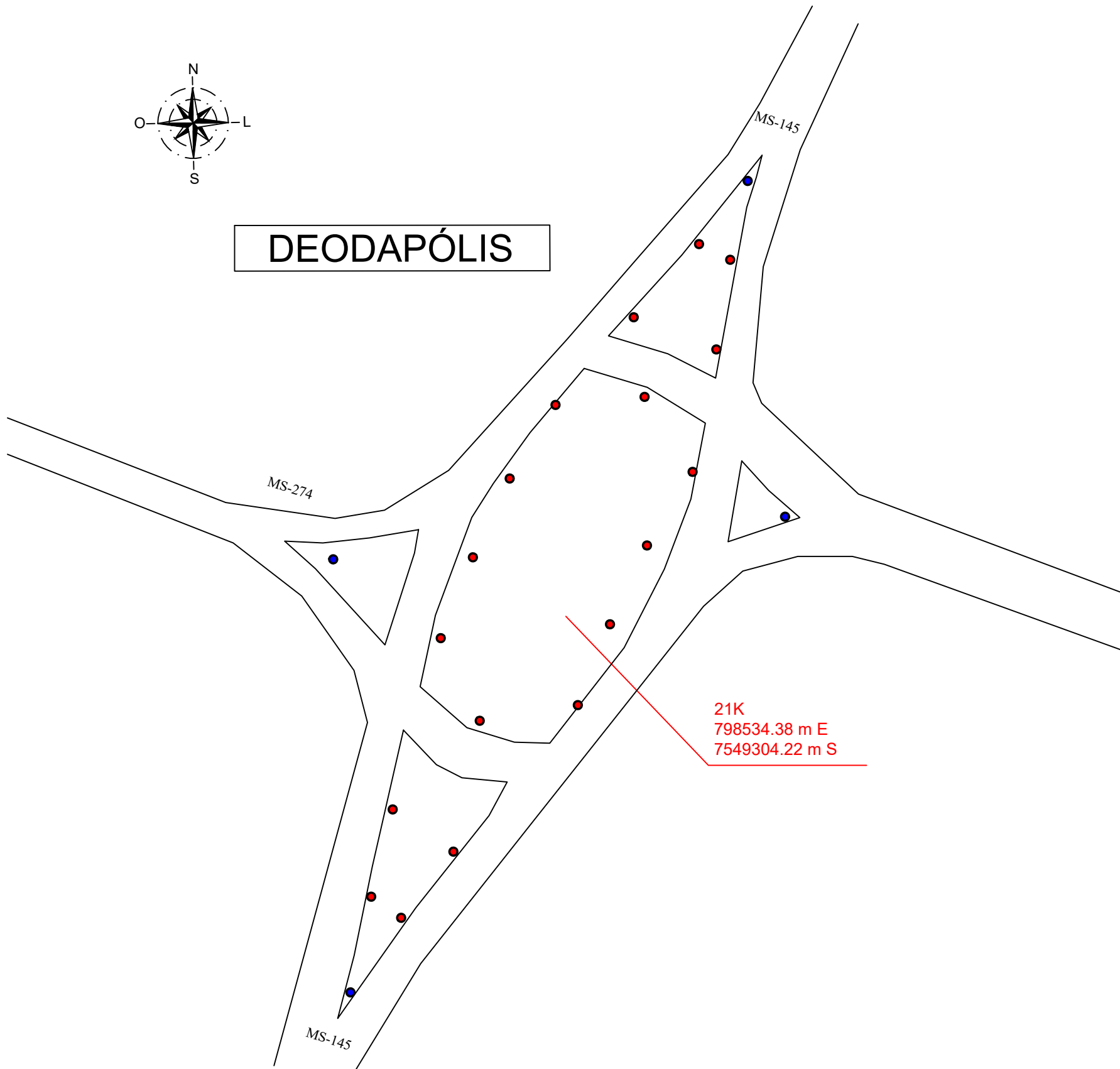
Trecho Implantação Led Solar e Postes (esc. 1:500)
