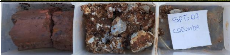
Foto 3.14– Amostras de solo obtidas no furo SPT-07.
