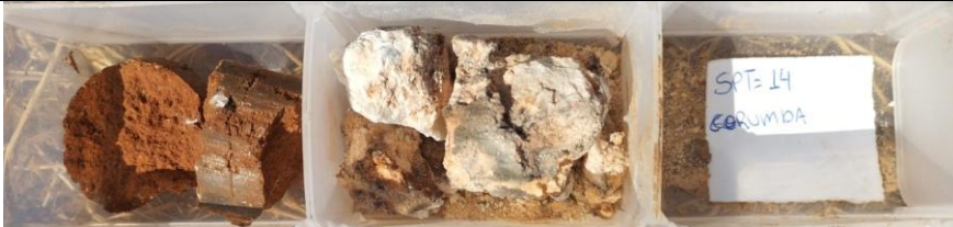
Foto 3.28– Amostras de solo obtidas no furo SPT-14.
