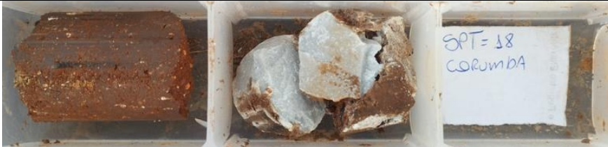
Foto 3.36– Amostras de solo obtidas no furo SPT-18.
