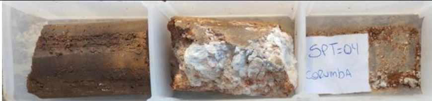
Foto 3.8– Amostras de solo obtidas no furo SPT-04.
