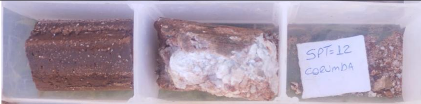
Foto 3.24– Amostras de solo obtidas no furo SPT-12.
