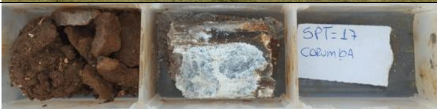
Foto 3.34– Amostras de solo obtidas no furo SPT-17.
