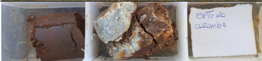
Foto 3.40– Amostras de solo obtidas no furo SPT-20.
