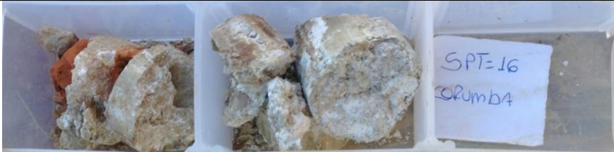
Foto 3.32– Amostras de solo obtidas no furo SPT-16.
