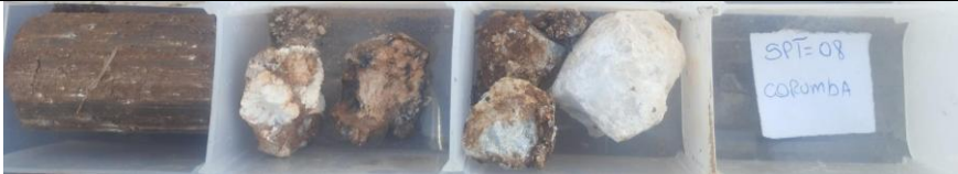
Foto 3.16– Amostras de solo obtidas no furo SPT-08.
