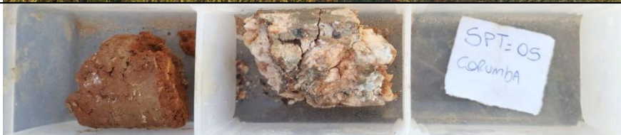
Foto 3.10– Amostras de solo obtidas no furo SPT-05.
