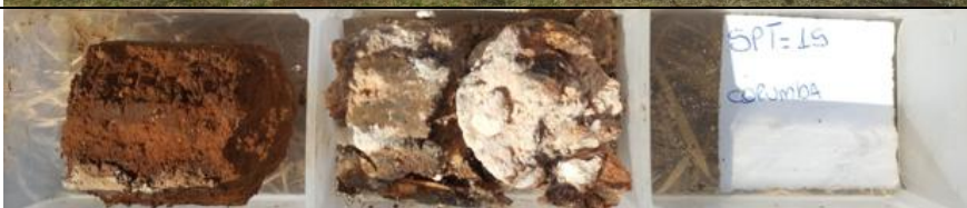
Foto 3.30– Amostras de solo obtidas no furo SPT-15.
