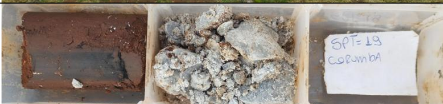
Foto 3.38– Amostras de solo obtidas no furo SPT-19.
