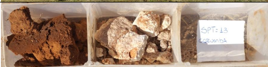
Foto 3.26– Amostras de solo obtidas no furo SPT-13.
