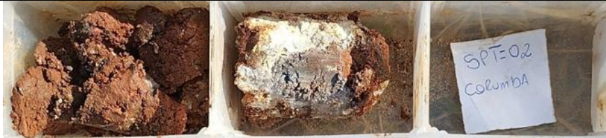
Foto 3.4– Amostras de solo obtidas no furo SPT-02.
