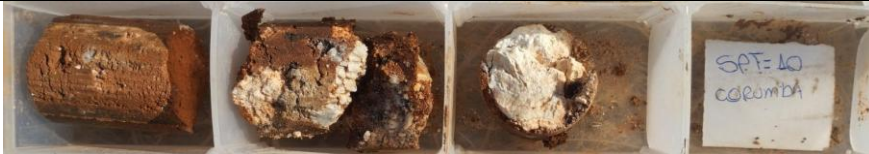
Foto 3.20– Amostras de solo obtidas no furo SPT-10.
