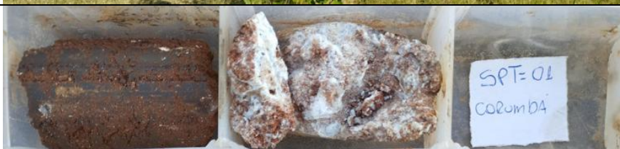
Foto 3.2– Amostras de solo obtidas no furo SPT-01.
