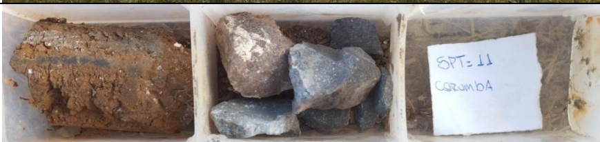
Foto 3.22– Amostras de solo obtidas no furo SPT-11.
