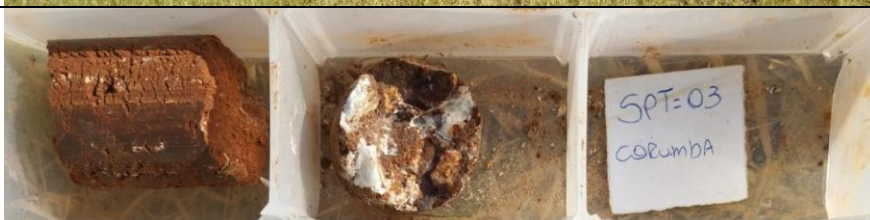
Foto 3.6– Amostras de solo obtidas no furo SPT-03.
