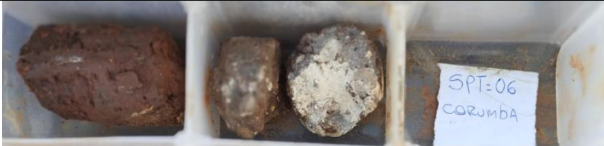
Foto 3.12– Amostras de solo obtidas no furo SPT-06.
