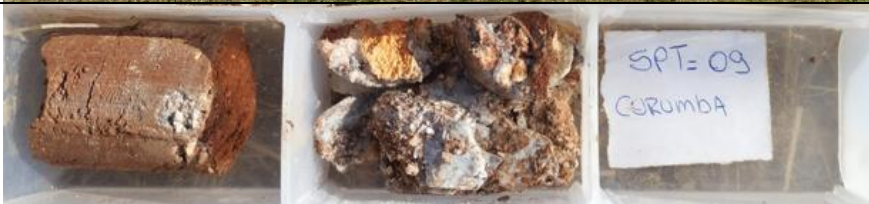
Foto 3.18– Amostras de solo obtidas no furo SPT-09.
