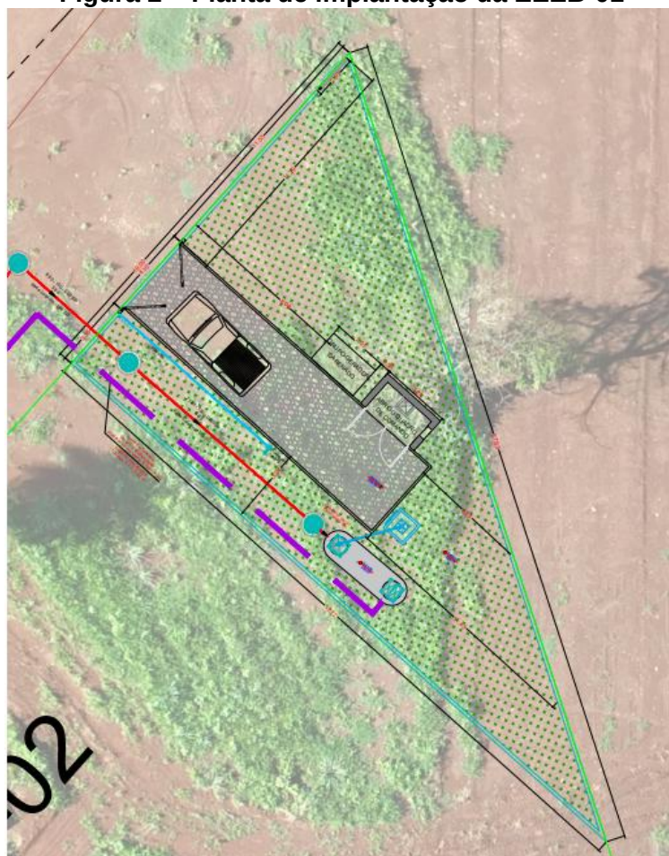
Figura 2 – Planta de implantação da EEEB-01
