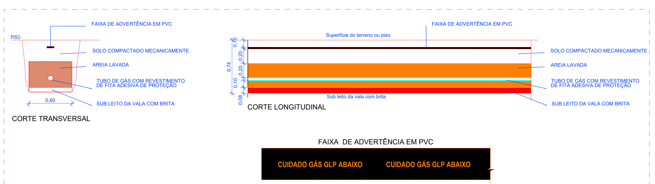
DETALHE - SISTEMA DE GÁS ATERRADO Escala: 1:25
