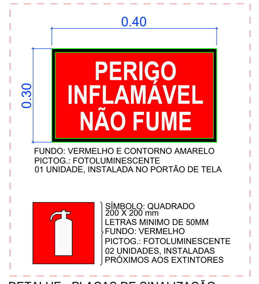
DETALHE - PLACAS DE SINALIZAÇÃO Escala: sem
