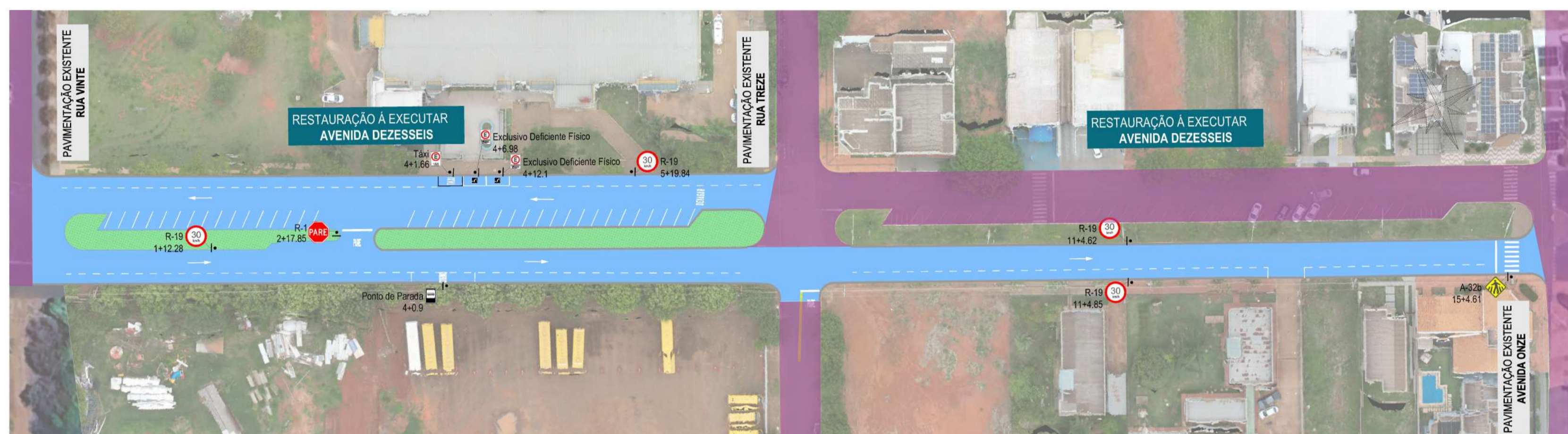
SINALIZAÇÃO À EXECUTAR - AV DEZESSEIS (TRECHO 1) ESCALA 1:750
