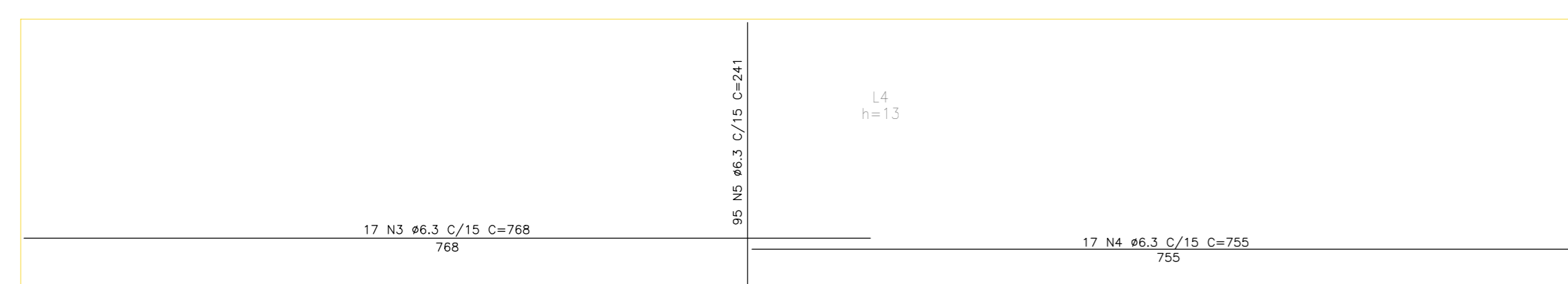
ARMAÇÃO INFERIOR LAJES PISO
