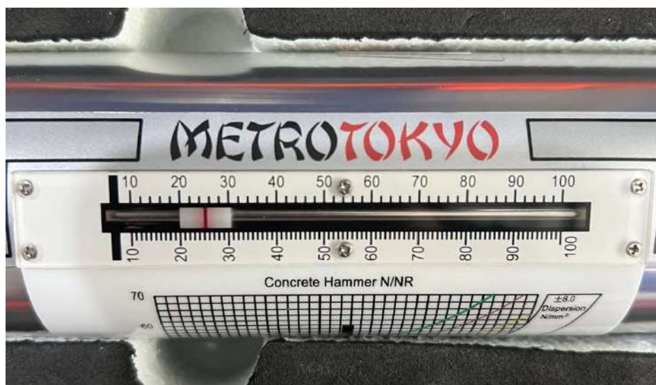
Figura 7 - Tabela para conversão do índice esclerométrico para resistência à compressão (MPa) (Fonte: O Autor)
