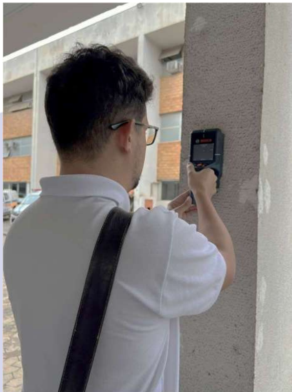
Figura 8 - Ensaio realizado utilizando o pacômetro no 18º BPM (Fonte: O Autor)
