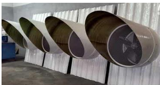
Fig. 12 – Proteção utilizando Pestanas
