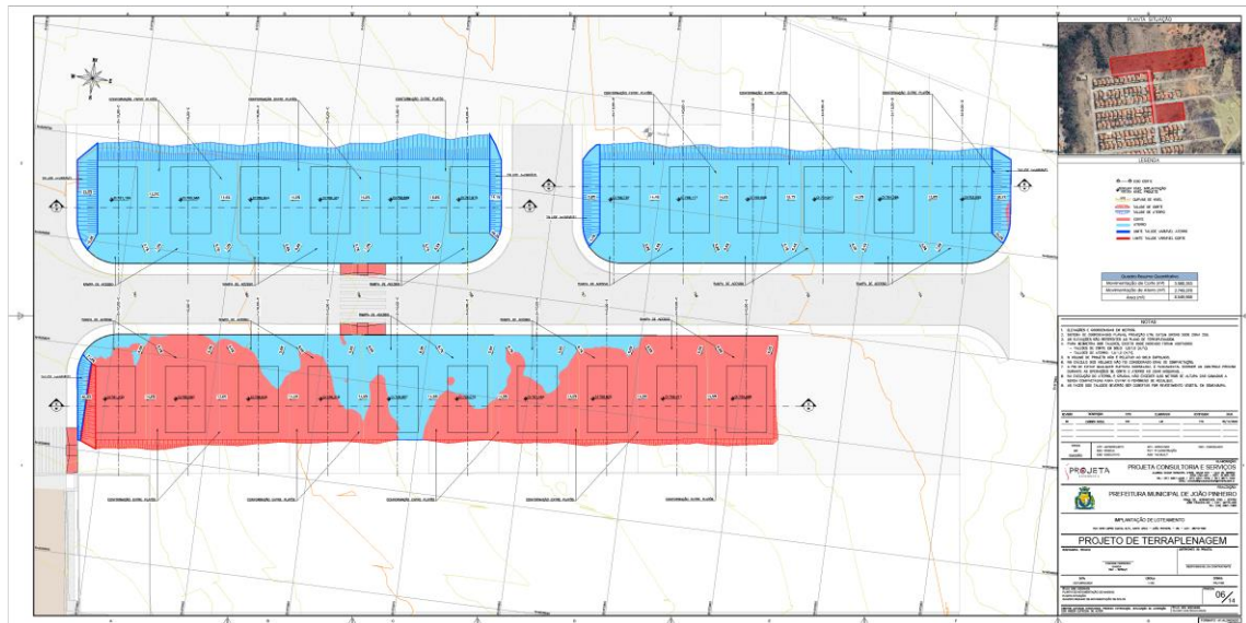
Figura 7 - Planta de movimentação de massas
