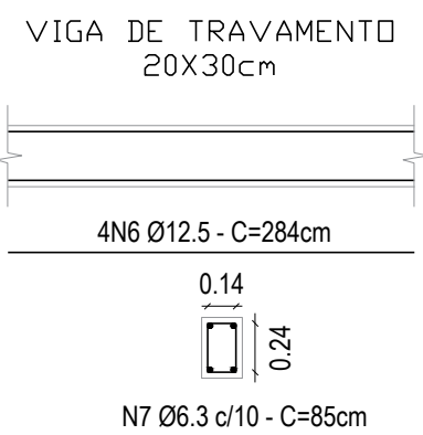
4 DETALHE VIGA DE TRAVAMENTO SEM ESCALA
