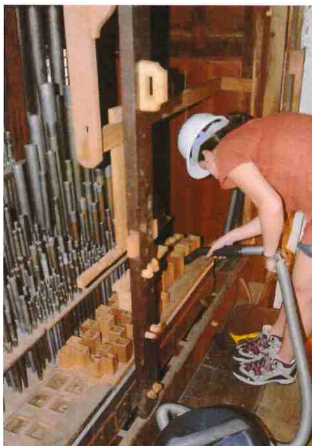
Figura 4. Limpeza durante o processo de desmontagem
