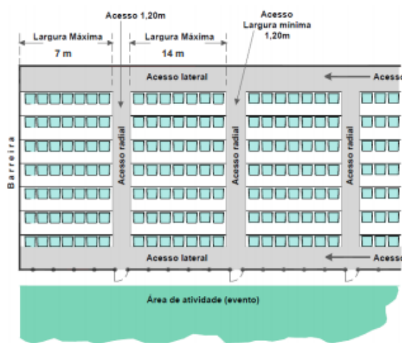
Figura H.2.2 - Arquibancada provisória
