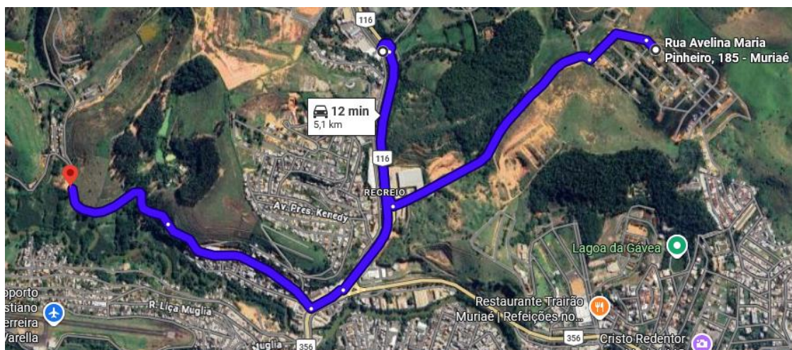
Figura 5 - Distância média de transporte - bota-fora
