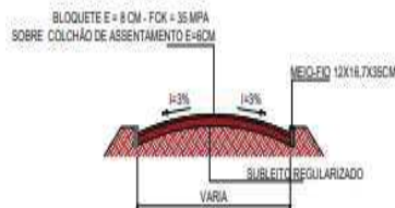
SEÇÃO TRANSVERSAL TIPO ESCALA 1/100
