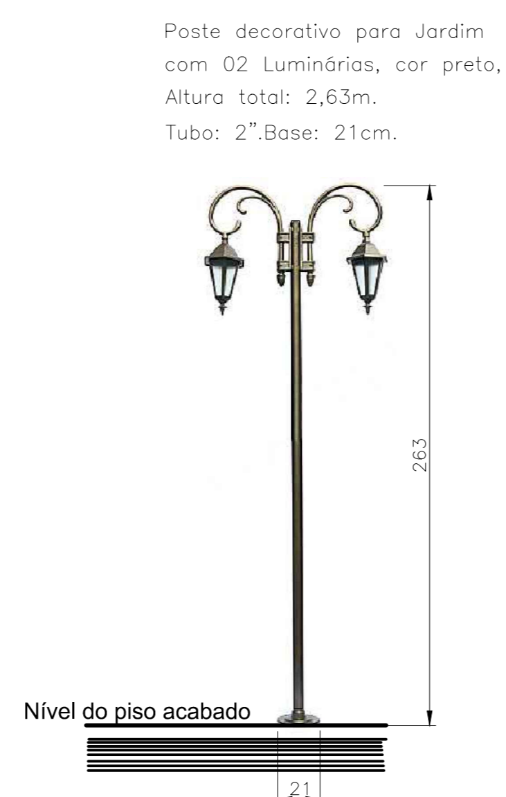
DETALHE DAS LUMINÁRIAS Esc. 1:25
