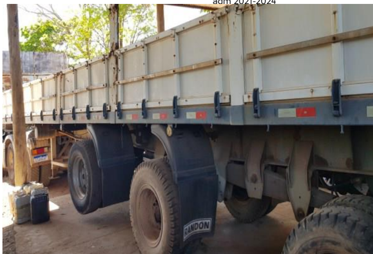
Foto 01 – Semirreboque RANDON- Vista lateral esquerda: com faixas refletivas
