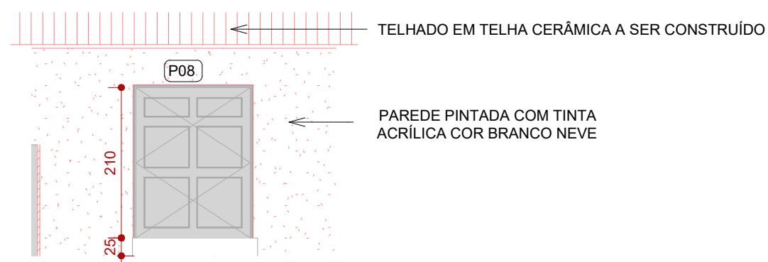
5 FACHADA FRONTAL DEPÓSITO 1 : 75
