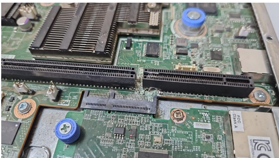
Figura 11: imagem das marcas de água na placa de circuito do servidor
