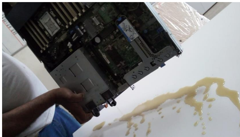
Figura 3: Imagem do servidor danificado pela chuva
