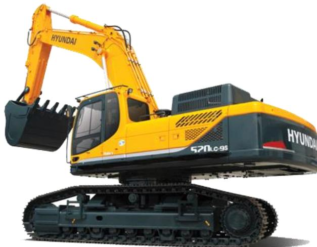
Função: Realiza escavações profundas, remoção de grandes volumes de terra e demolição de estruturas.
