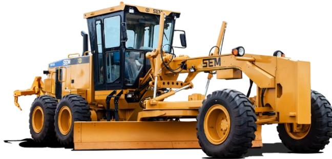
Função: Nivela terrenos, ajusta a superfície de estradas e distribui materiais de forma uniforme.
