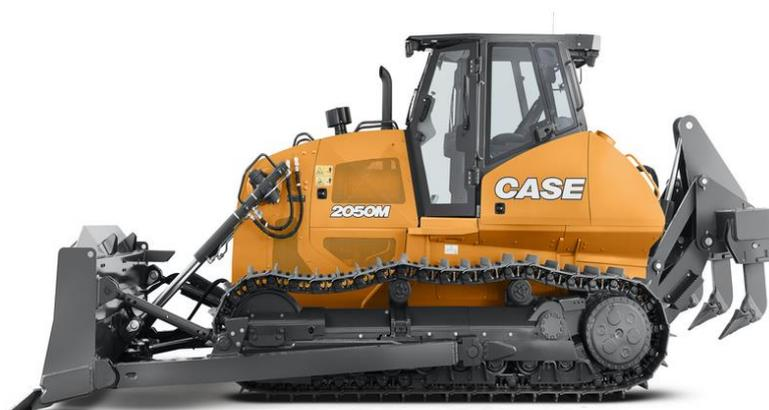
Função: Movimenta grandes quantidades de terra, realiza terraplanagem e auxilia na construção de estradas.
