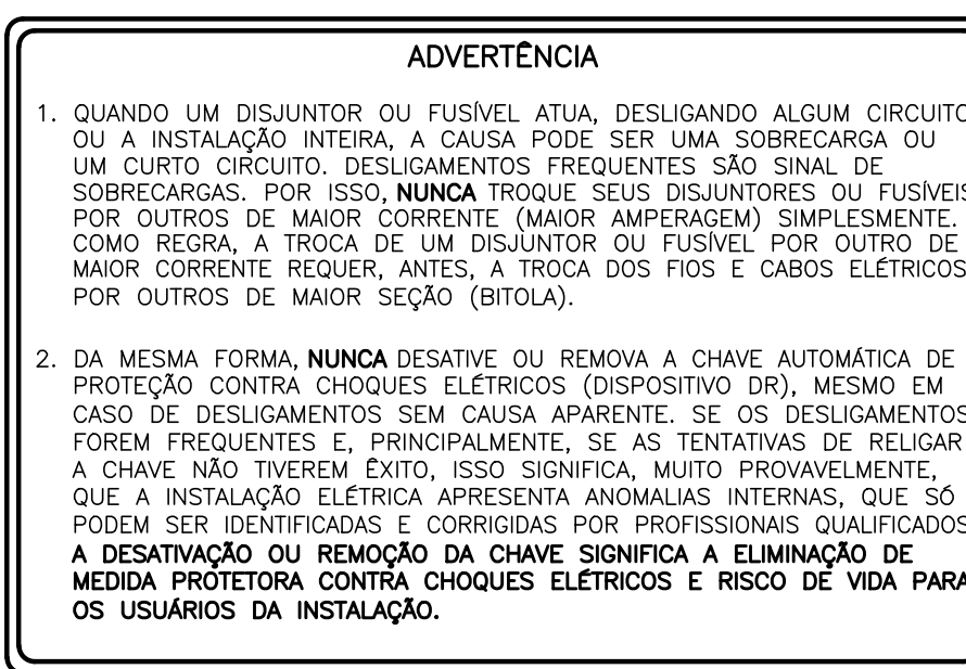
DETALHE DO QUADRO DE ADVERTÊNCIA
