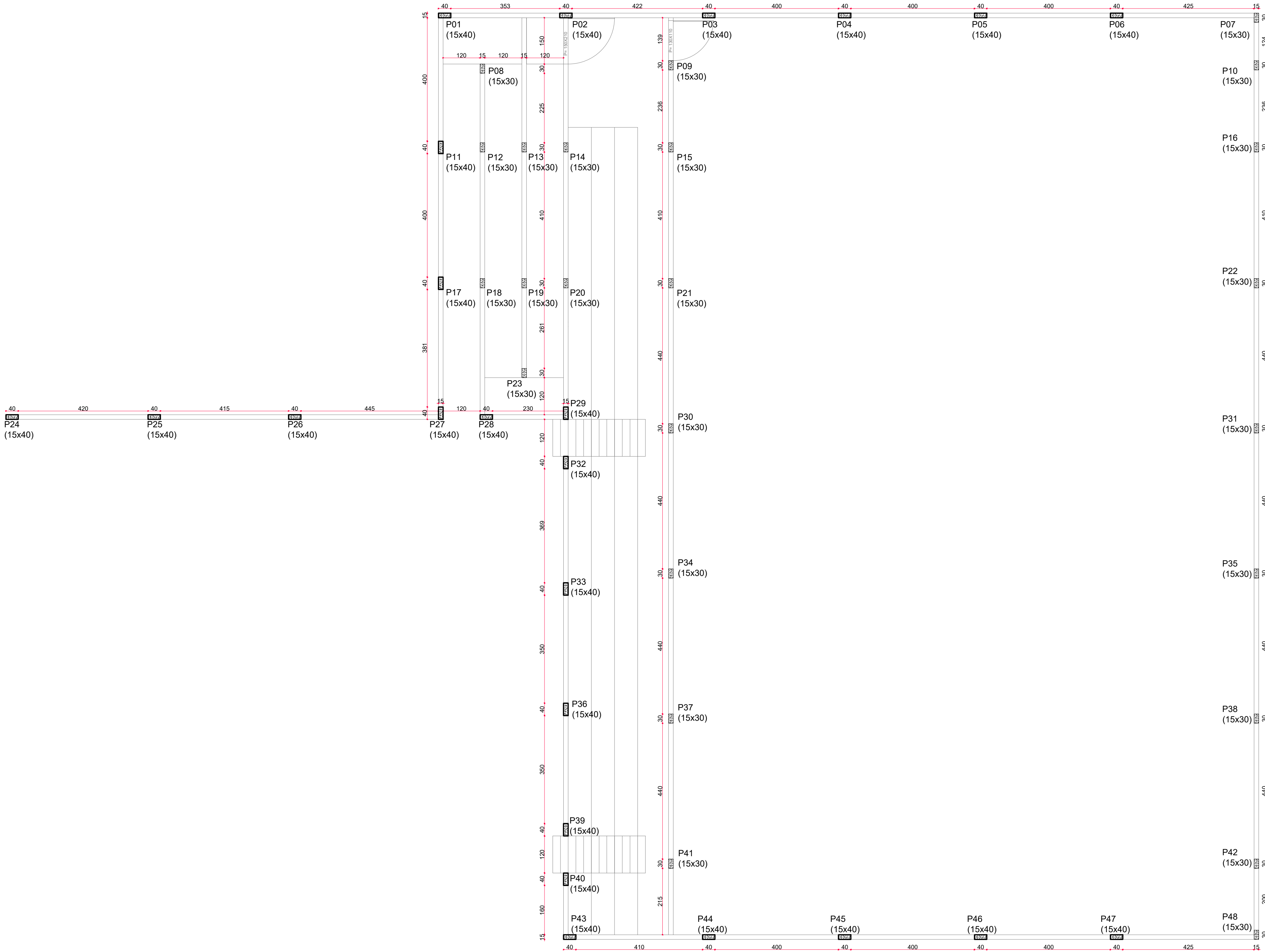
locação de pilares esc 1:75
