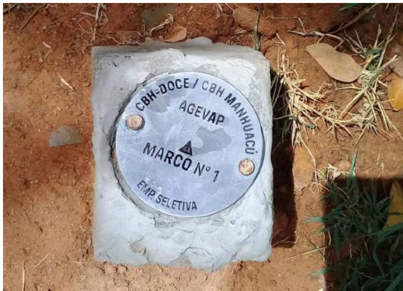
Figura 7 - Exemplo de marco topográfico
