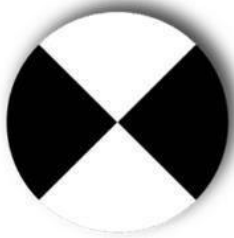
Figura 8 – Exemplo de pontos de controle terrestres (GCPs)
