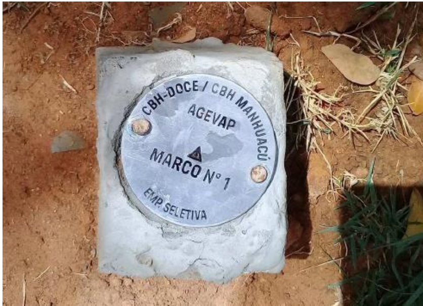
Figura 7 – Exemplo de marco topográfico
