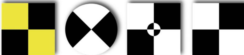
Figura 8 – Exemplo de pontos de controle terrestres (GCPs)
