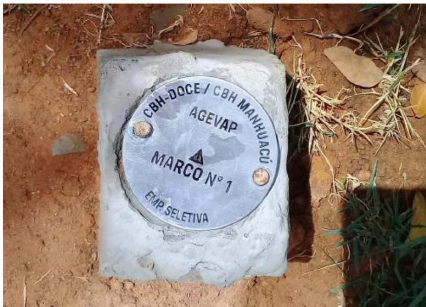
Figura 7 – Exemplo de marco topográfico
