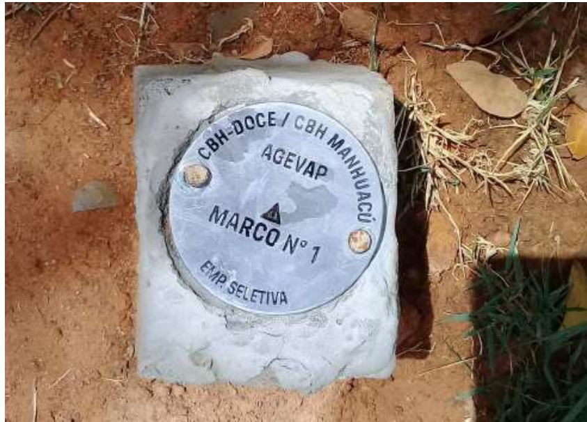
Figura 8 – Exemplo de marco topográfico
