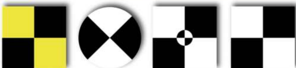
Figura 9 – Exemplo de pontos de controle terrestres (GCPs)
