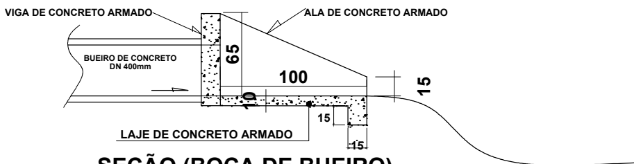
SEÇÃO (BOCA DE BUEIRO) SEM ESCALA
