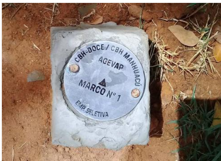
Figura 8 – Exemplo de marco topográfico
