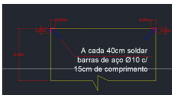
Figura 03. Detalhe cantoneira de aço carbono
