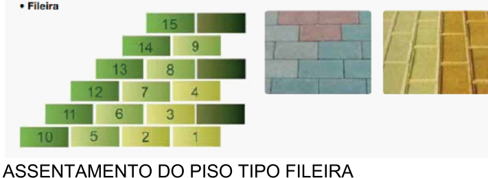
ASSENTAMENTO DO PISO TIPO FILEIRA
