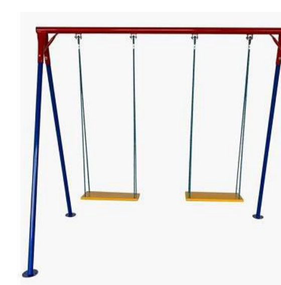
BALANÇO DE FERRO DUPLA, COM TUBO DE AÇO, CADEIRINHA EM MADEIRA DE LEI, CORRENTES GALVANIZADAS E FIXADORES "CASTANHAS" PARA QUE NÃO HAJA DESGASTE NOS ELOS DAS CORRENTES. PINTURA: ESMALTE INDUSTRIAL E FUNDO ANTI-CORROSIVO.
