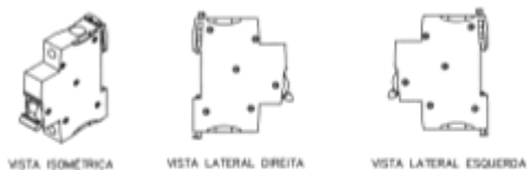
DETALHE DISJUNTOR DIN MONOPOLAR
