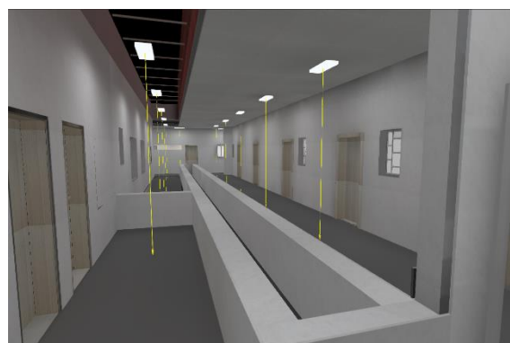
Figura 36: Resultado da Simulação no Dialux (Cores reais) – Corredor 1º pavimento
