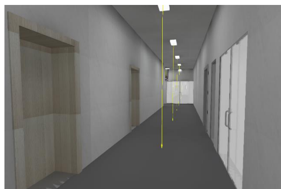
Figura 32: Resultado da Simulação no Dialux (Cores reais) – Corredor 1º pavimento
