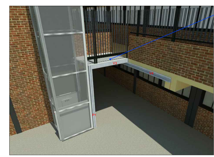
REPRESENTAÇÕES GRÁFICAS DO PROJETO DO PATAMAR DE ACESSO ENTRE A PLATAFORMA ELEVATÓRIA E O PISO SUPERIOR, DESENVOLVIDAS COMO SUPORTE À EXECUÇÃO DA OBRA.
