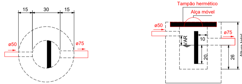
Caixa de gordura Planta baixa - ESC. 1:25
