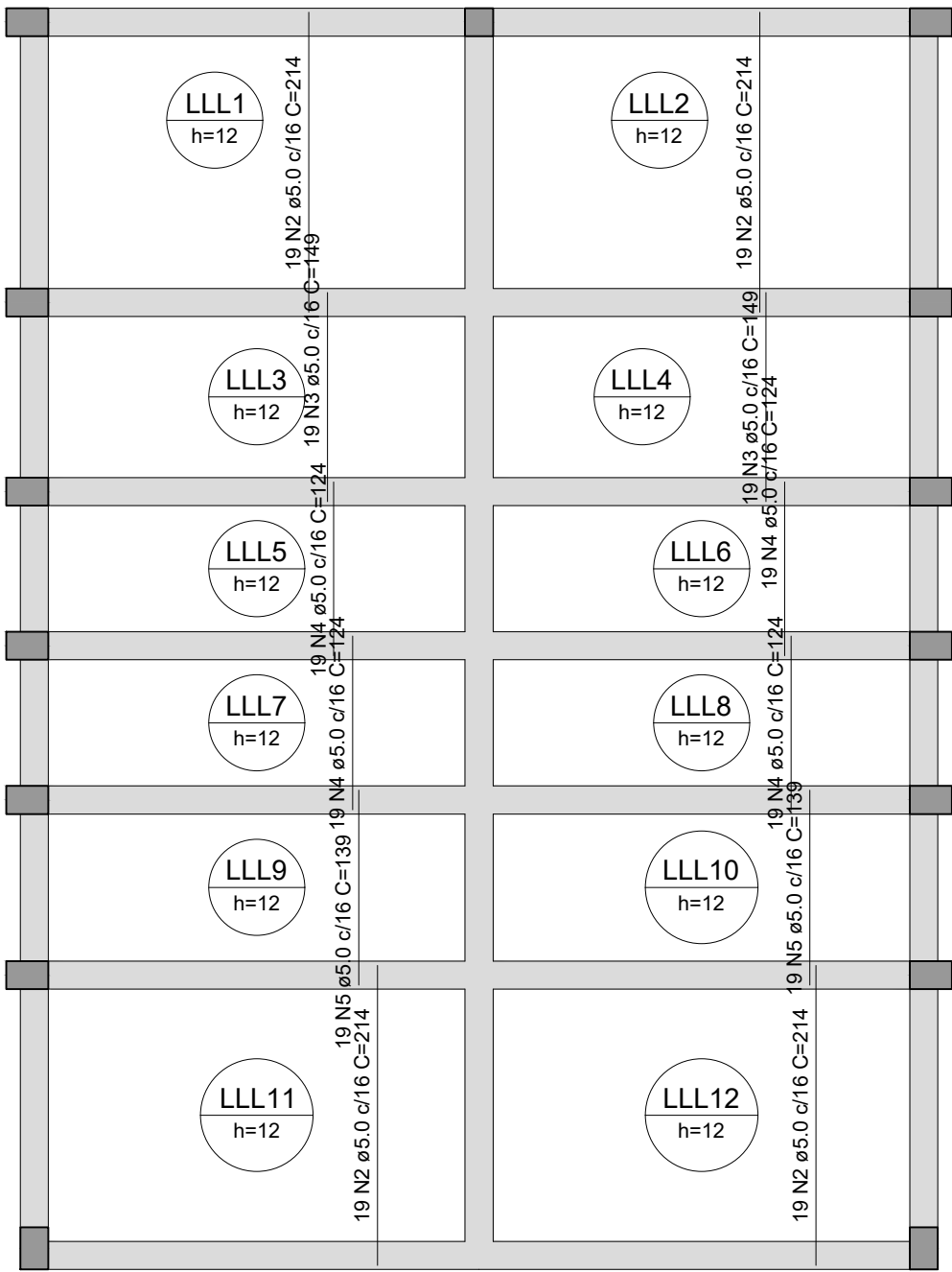
ARMAÇÃO POSITIVA DAS LAJES DO PAVIMENTO LAJE 2 (EIXO Y)
