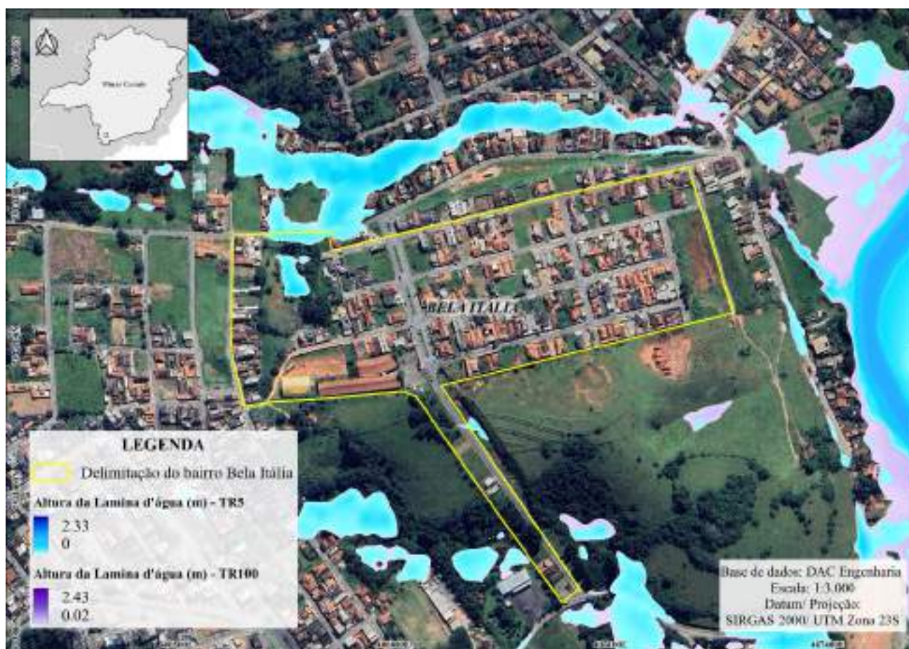
Figura 16 – Mancha de acúmulo hidráulico do bairro Bella Itália para um TR de 5 e 100 anos
