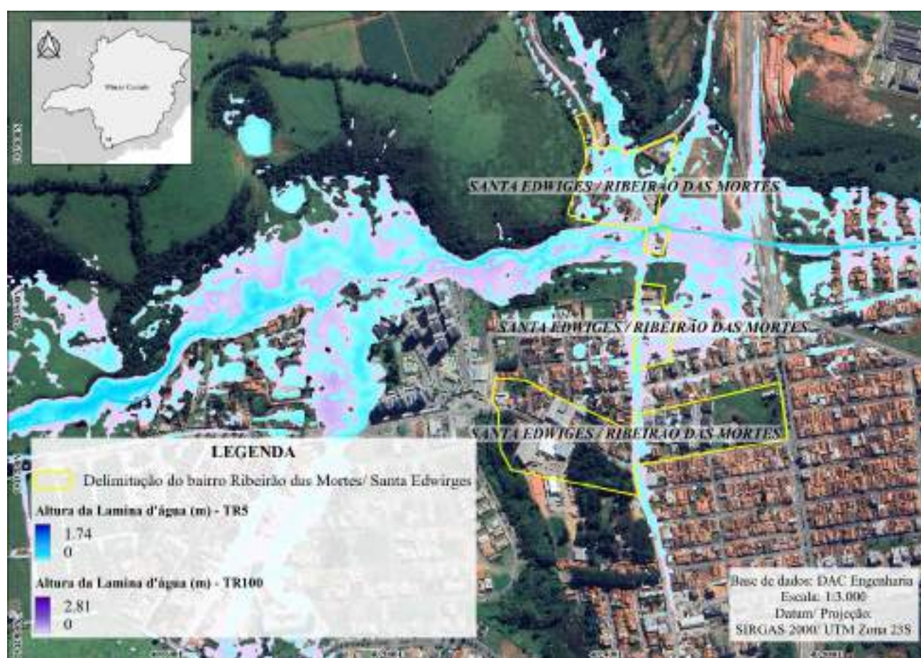
Figura 97 – Mancha de acúmulo hidráulico do bairro Ribeirão das MorteS/Santa EdwigeS para um TR de 5 e 100 anos
