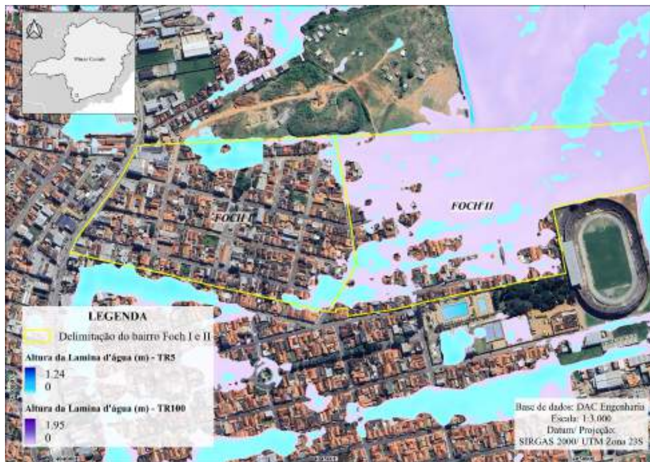
Figura 58 – Mancha de acúmulo hidráulico do bairro Foch I e II para um TR de 5 e 100 anos
