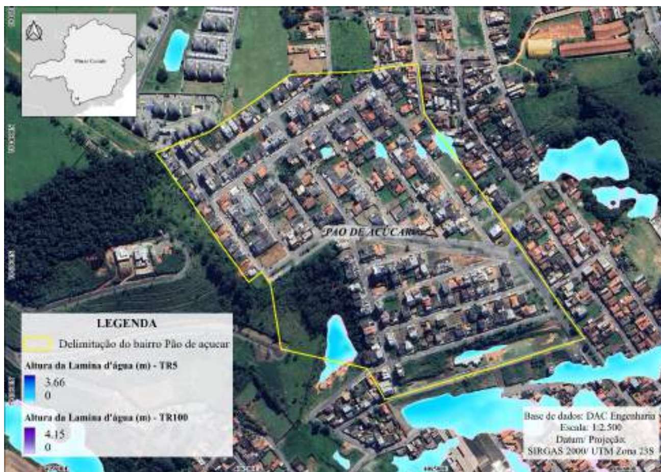
Figura 90 – Mancha de acúmulo hidráulico do bairro Pão de Açúcar para um TR de 5 e 100 anos
