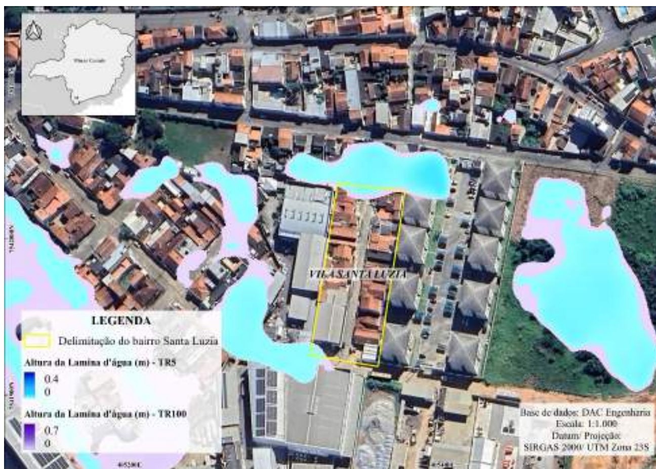
Figura 108 – Mancha de acúmulo hidráulico do bairro Santa Luzia para um TR de 5 e 100 anos
