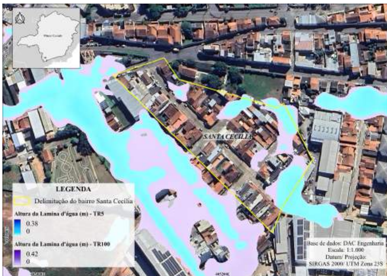
Figura 100 – Mancha de acúmulo hidráulico do bairro Santa Cecília para um TR de 5 e 100 anos
