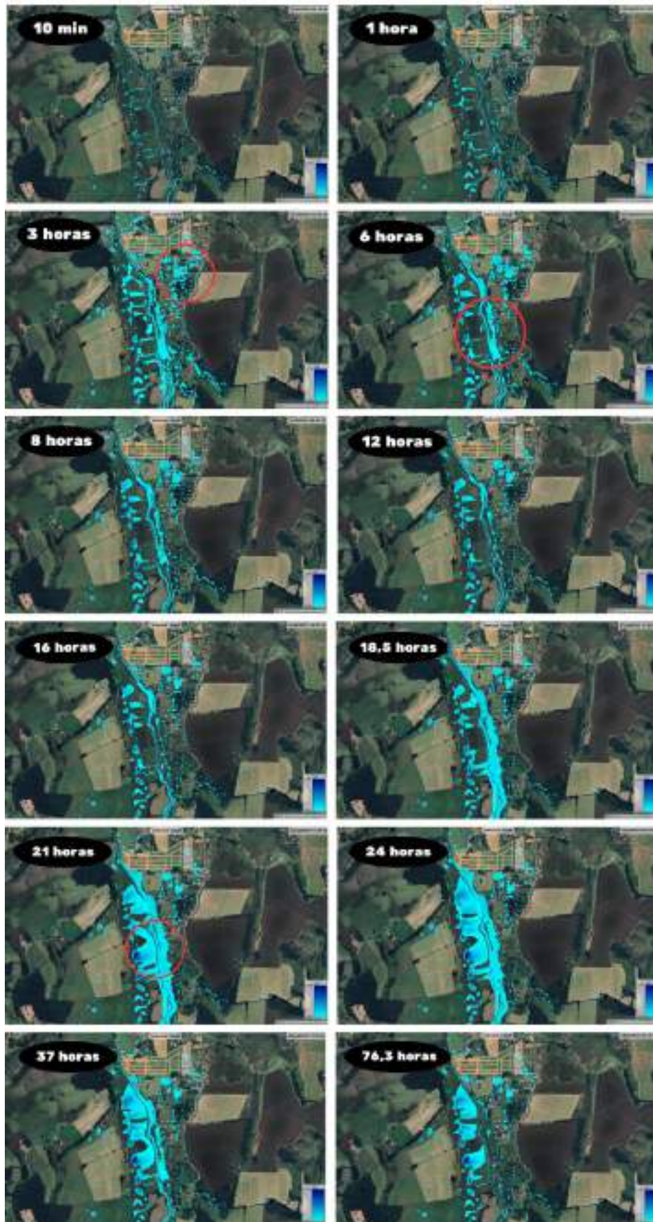
Figura 92 - Evolução da mancha de acúmulo hidráulico do Ribeirão Pantano (TR 50)
