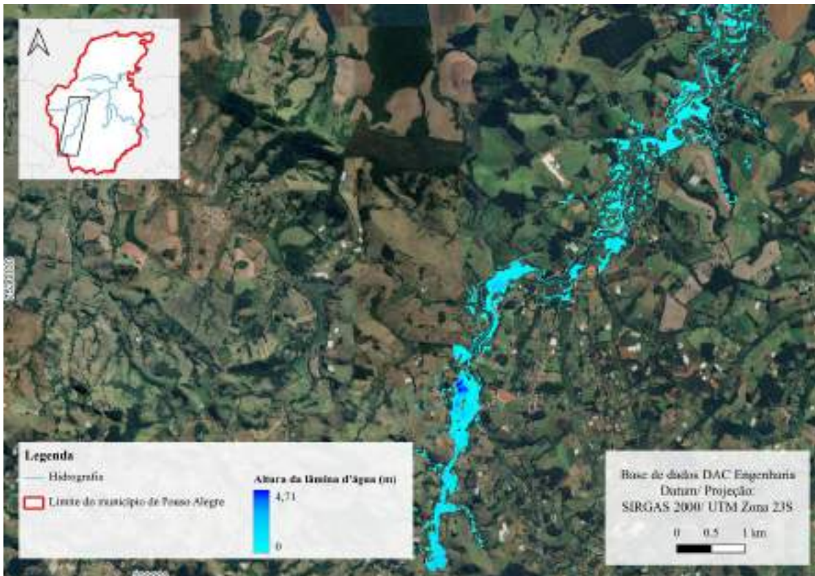
Figura 78 - Mancha de acúmulo hidráulico do Ribeirão Pantano – TR 5 (Cena 1)
