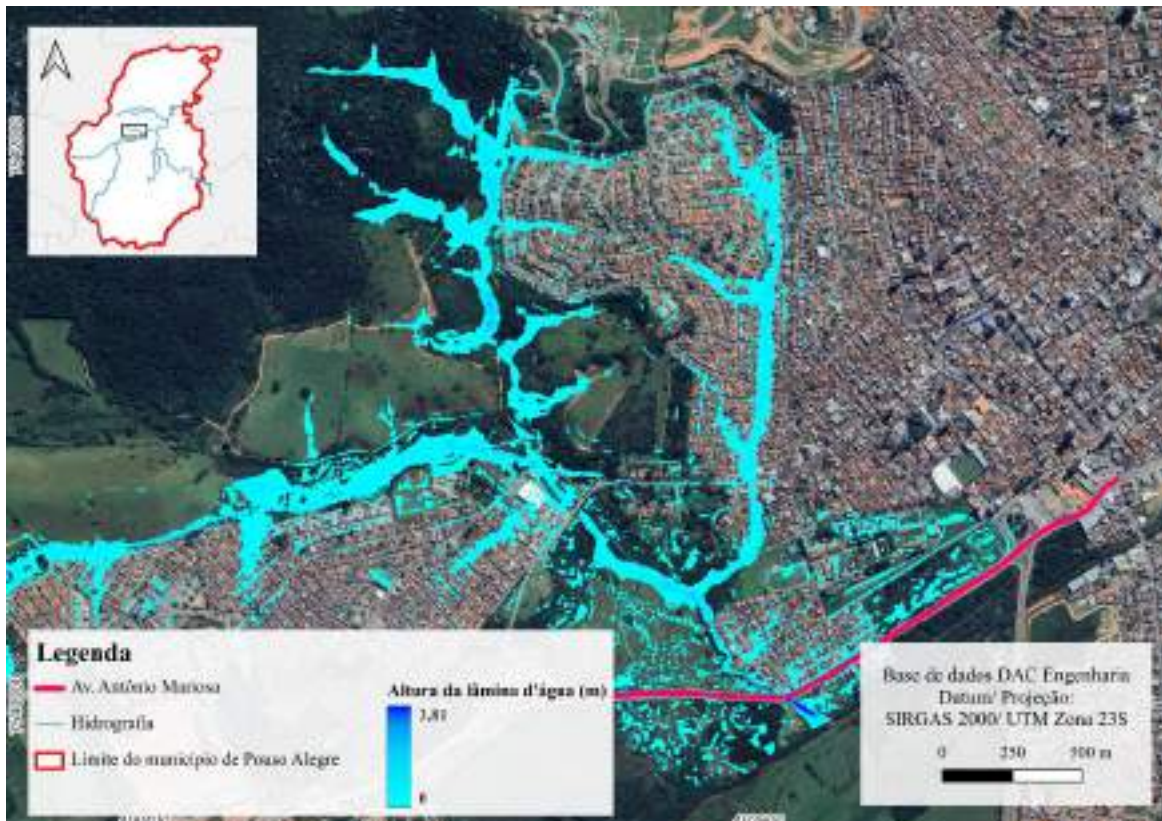
Figura 24 – Mancha de acúmulo hidráulico para o Córrego da Remonta – TR 5 (Cena 1)
