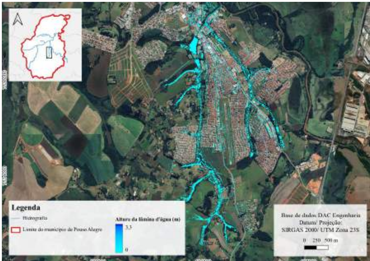
Figura 43 - Mancha de acúmulo hidráulico para o Córrego do Patinho – TR 10
