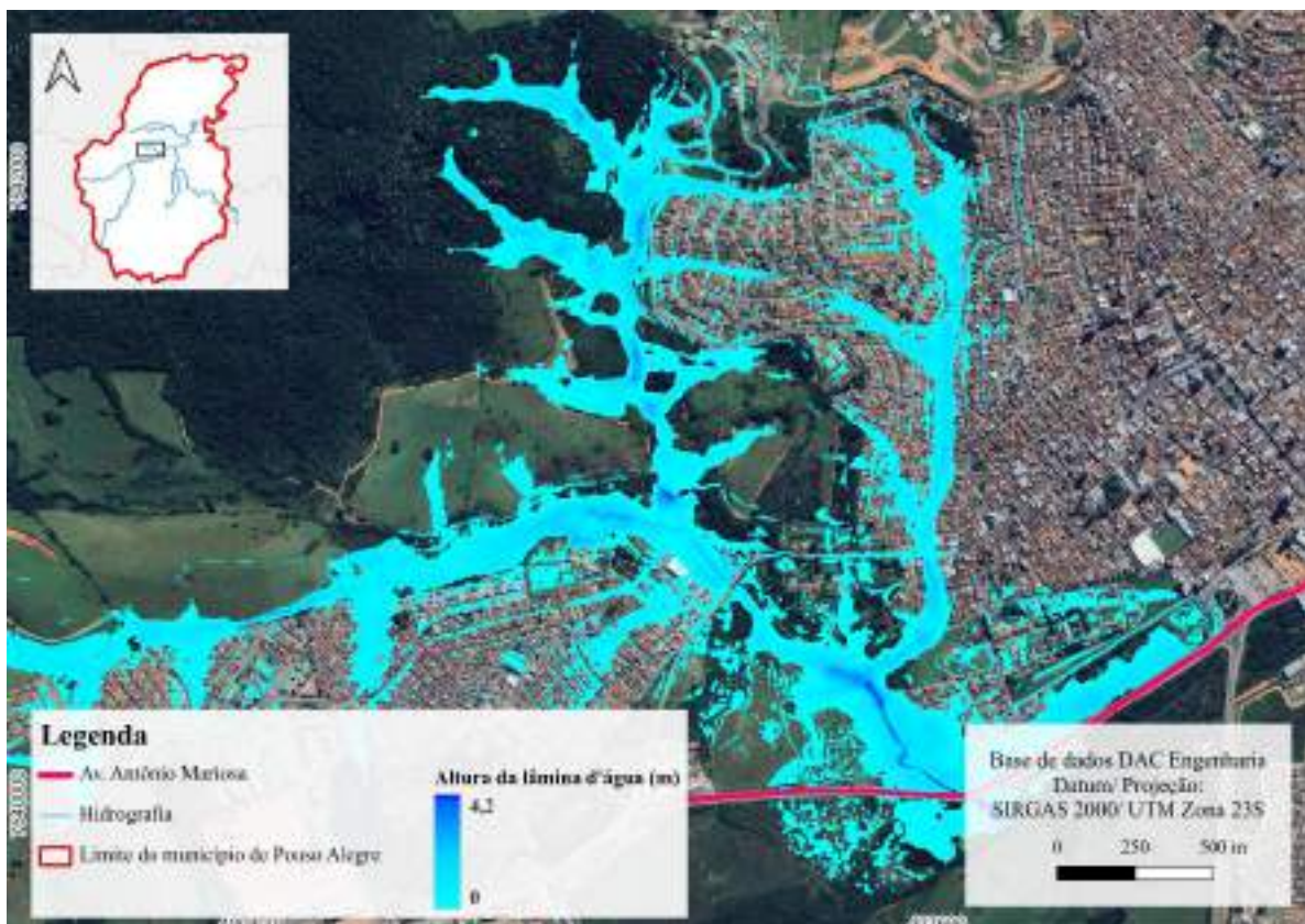
Figura 36 – Mancha de acúmulo hidráulico para o Córrego da Remonta – TR 100 (Cena 1)
