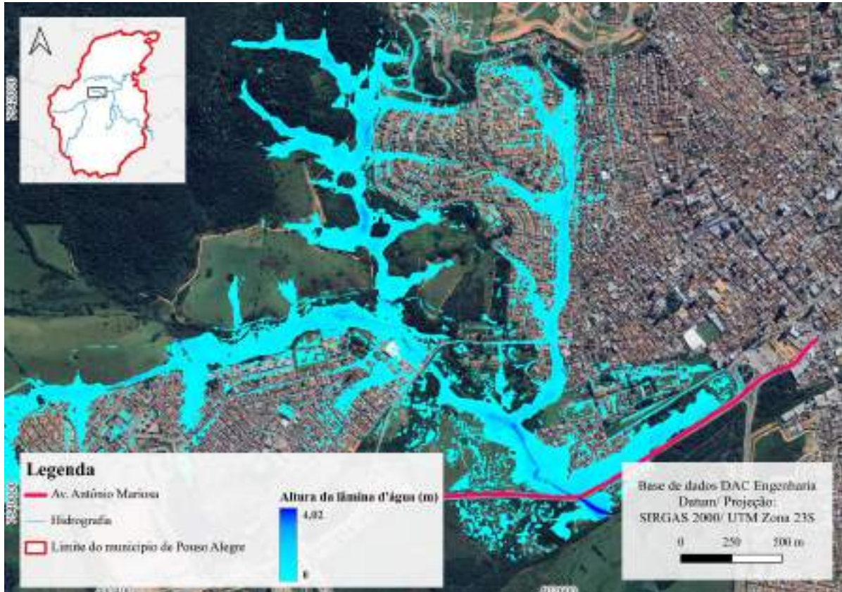
Figura 30 – Mancha de acúmulo hidráulico para o Córrego da Remonta – TR 25 (Cena 1)
