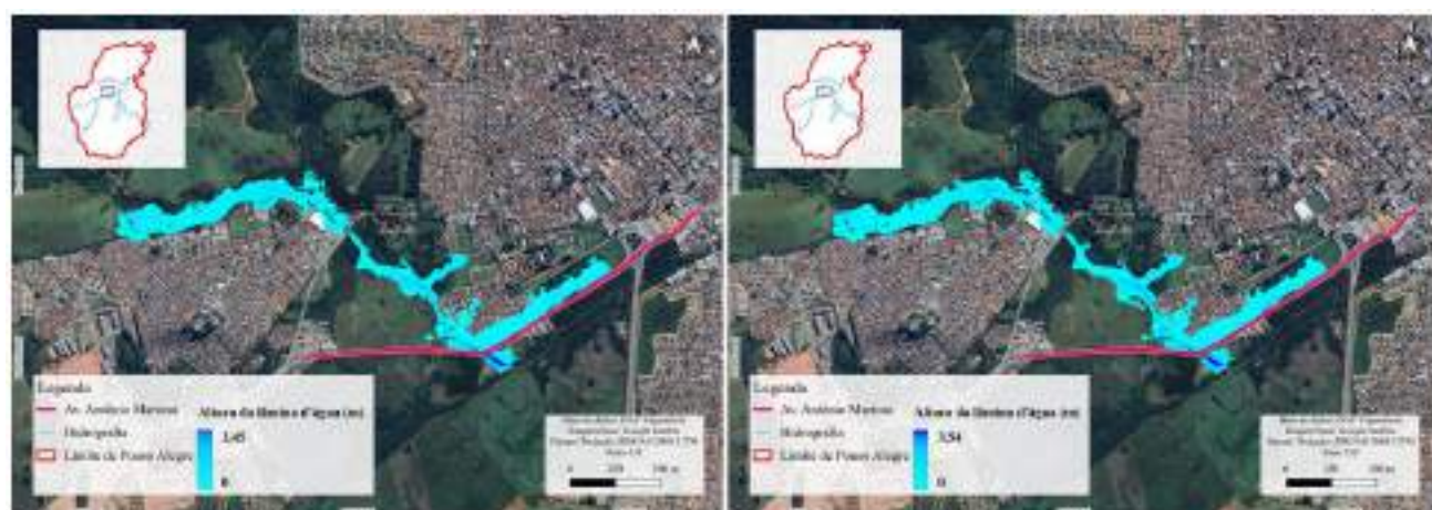
Figura 109 - Mancha de inundação para o TR 10 anos para o Córrego da Remonta para os anos de 2025 e 2045, respectivamente
