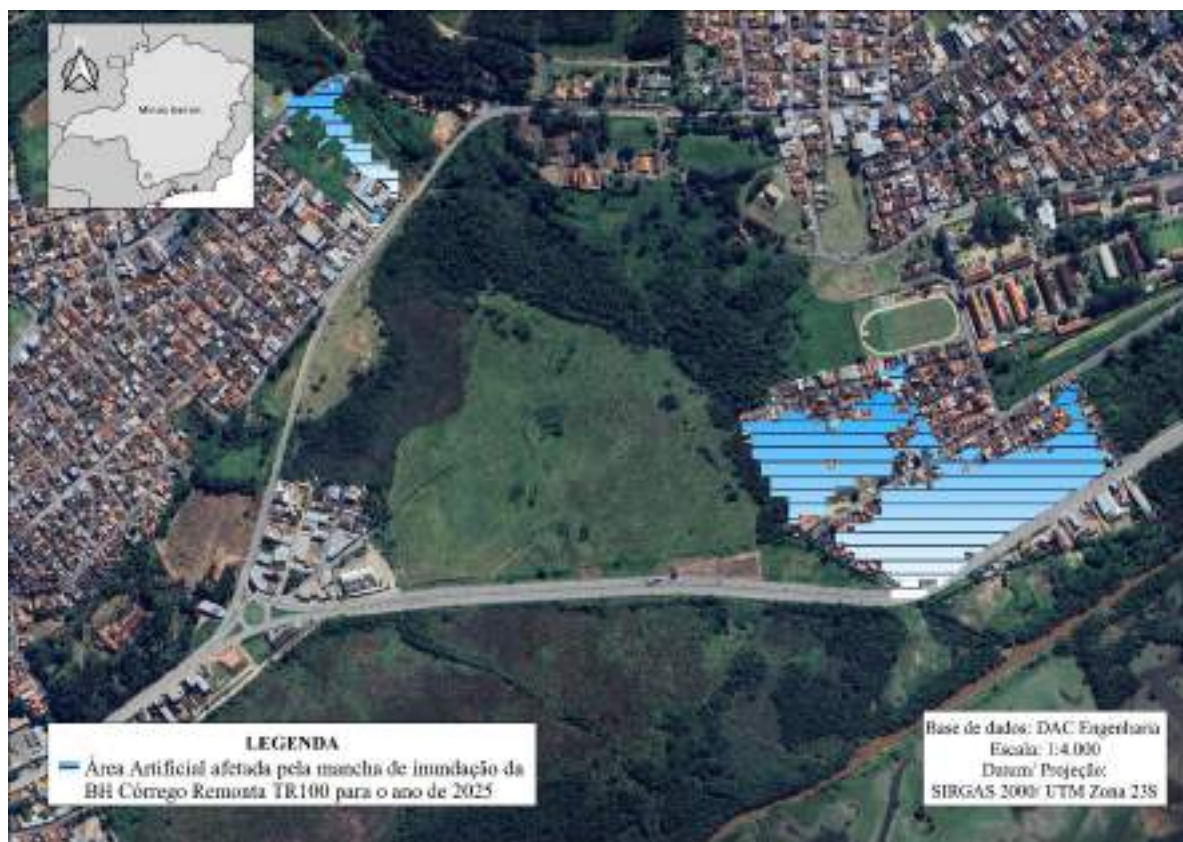
Figura 175 – Cruzamento entre a área artificial de 2025 e a mancha de inundação do Córrego da Remonta (TR 100)
