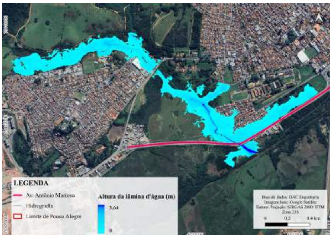
Figura 17 – Mancha de Inundação do Córrego da Remonta para o TR 25 anos
