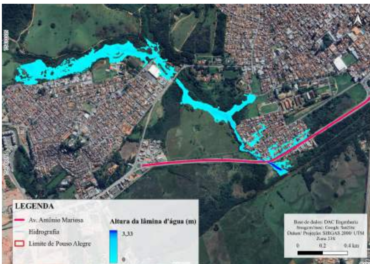
Figura 15 – Mancha de Inundação do Córrego da Remonta para o TR 5 anos
