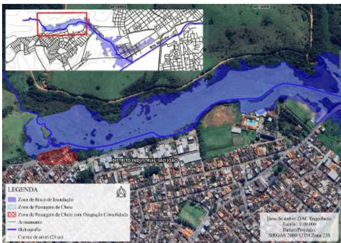
Figura 148 – Zoneamento de Planície de Inundação no Trecho 1 (Cór. Remonta)
