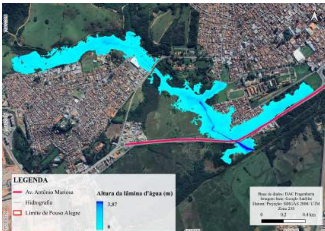
Figura 18 – Mancha de Inundação do Córrego da Remonta para o TR 50 anos
