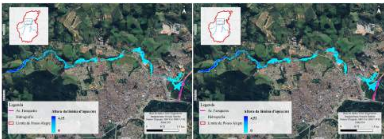
Figura 122 - Mancha de inundação para o TR 100 anos para o Ribeirão das Mortes para os anos de 2025 e 2045, respectivamente
