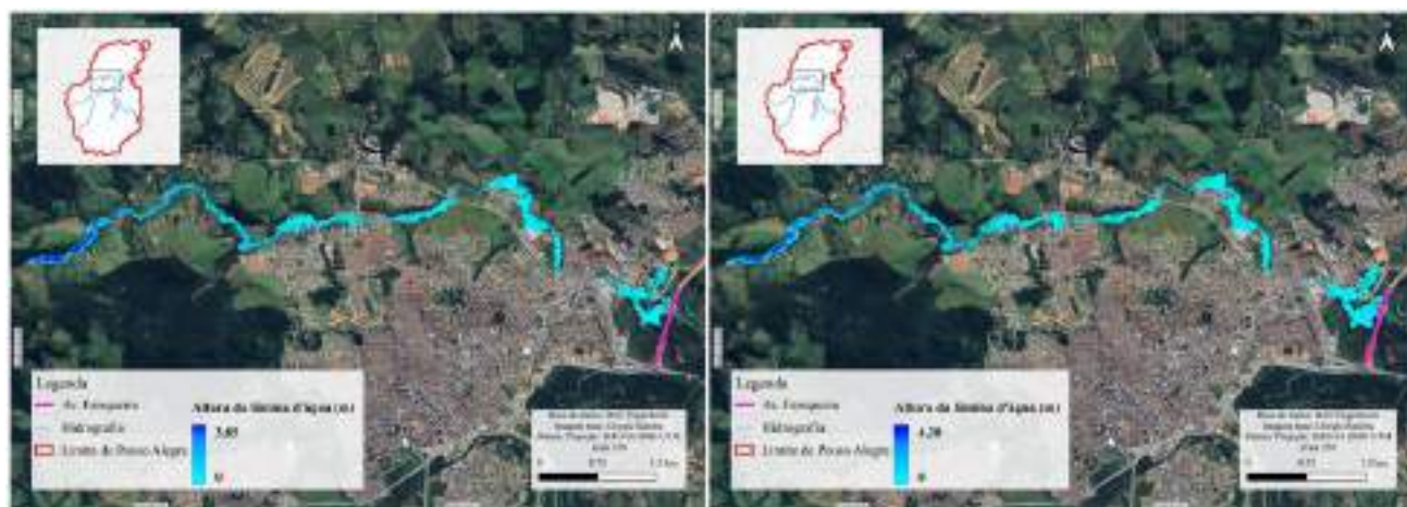
Figura 120 - Mancha de inundação para o TR 25 anos para o Ribeirão das Mortes para os anos de 2025 e 2045, respectivamente
