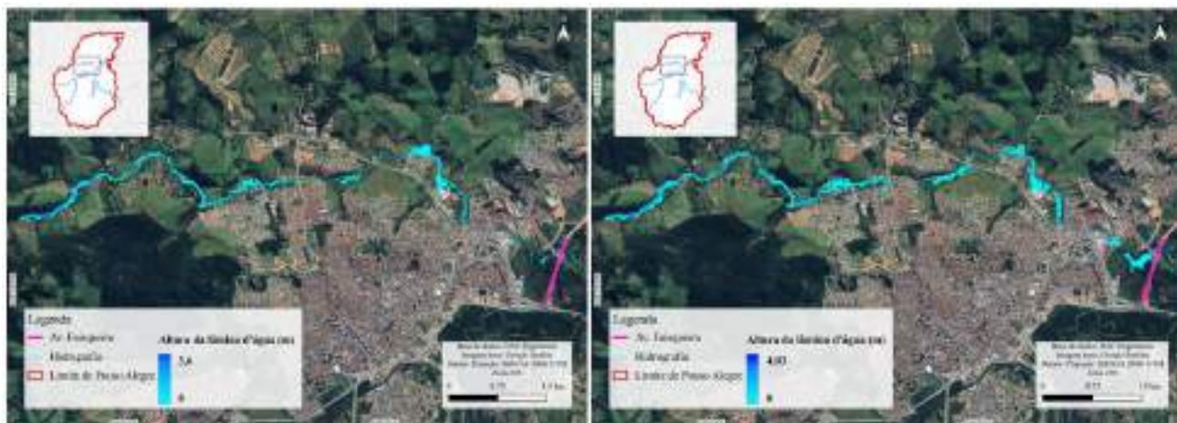
Figura 118 - Mancha de inundação para o TR 5 anos para o Ribeirão das Mortes para os anos de 2025 e 2045, respectivamente
