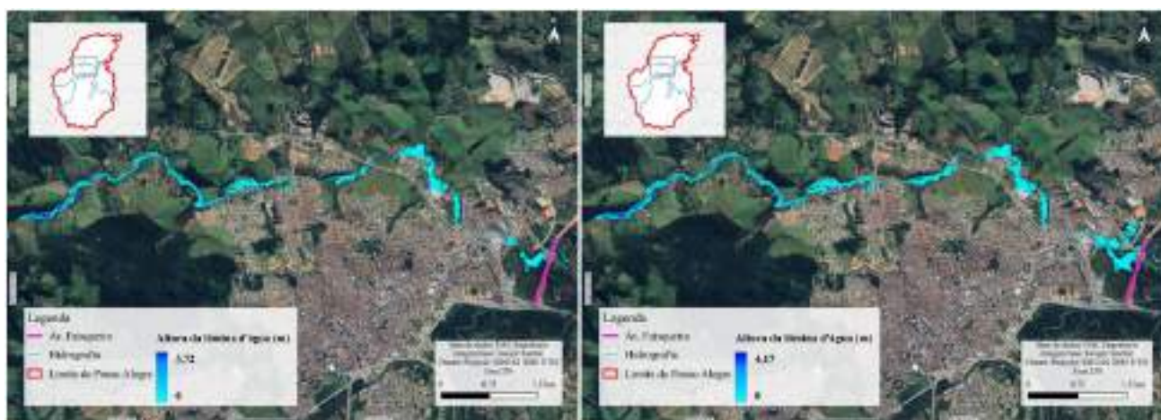
Figura 119 - Mancha de inundação para o TR 10 anos para o Ribeirão das Mortes para os anos de 2025 e 2045, respectivamente
