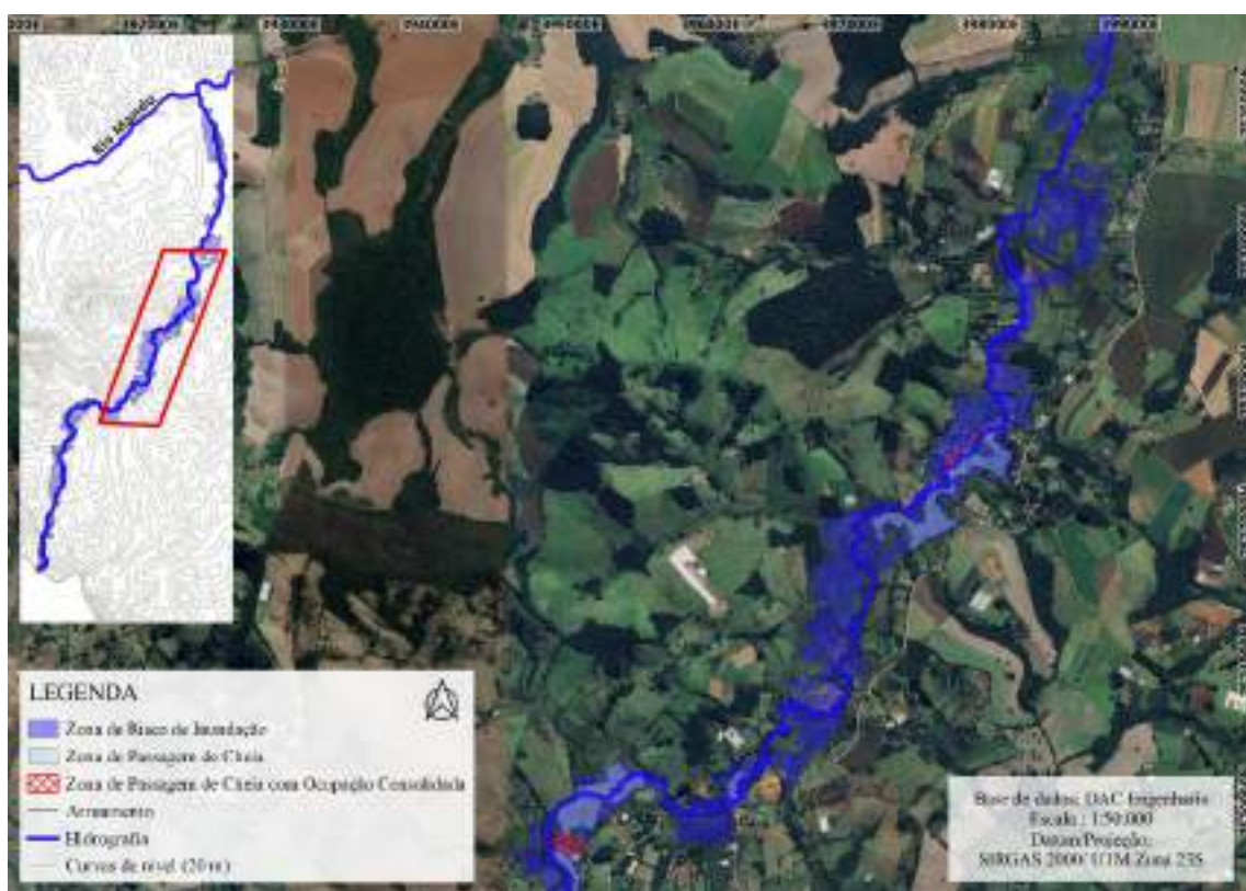
Figura 159 - Zoneamento de Planície de Inundação no Trecho 2 (Rib. Pantano)
