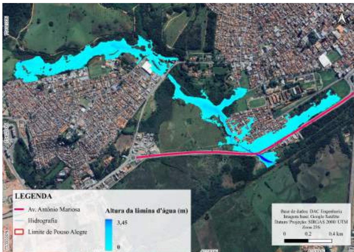
Figura 16 – Mancha de Inundação do Córrego da Remonta para o TR 10 anos
