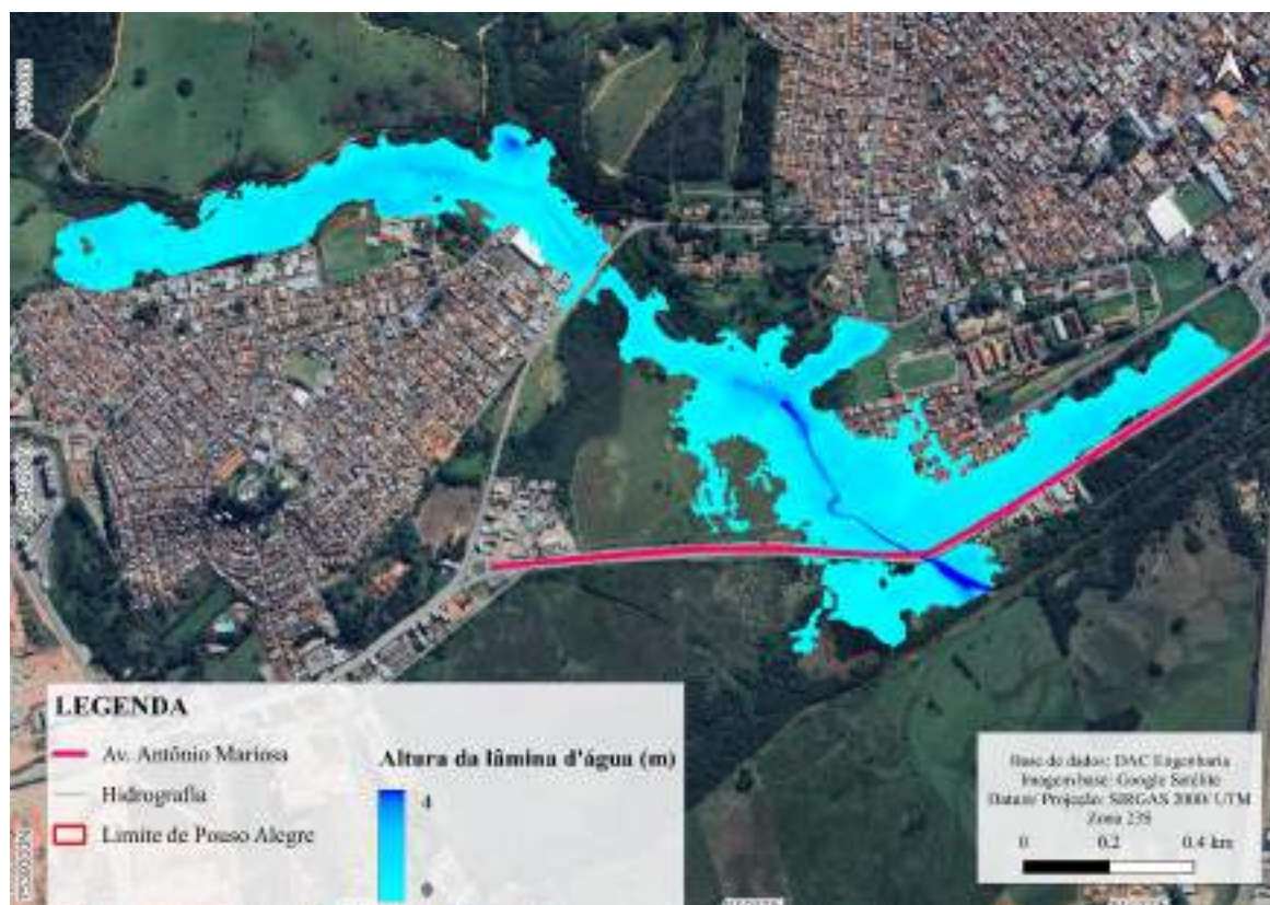
Figura 19 – Mancha de Inundação do Córrego da Remonta para o TR 100 anos
