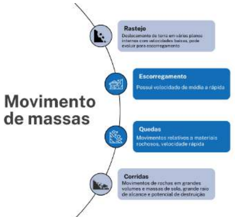
Figura 103 – Tipologias dos deslizamentos de massa
