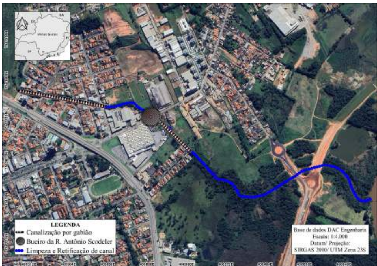
Figura 138 - Canalização por gabião do ribeirão das Mortes
