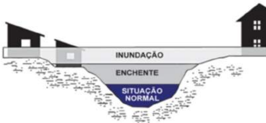
Figura 92 – Denominação da seção transversal do curso hídrico
