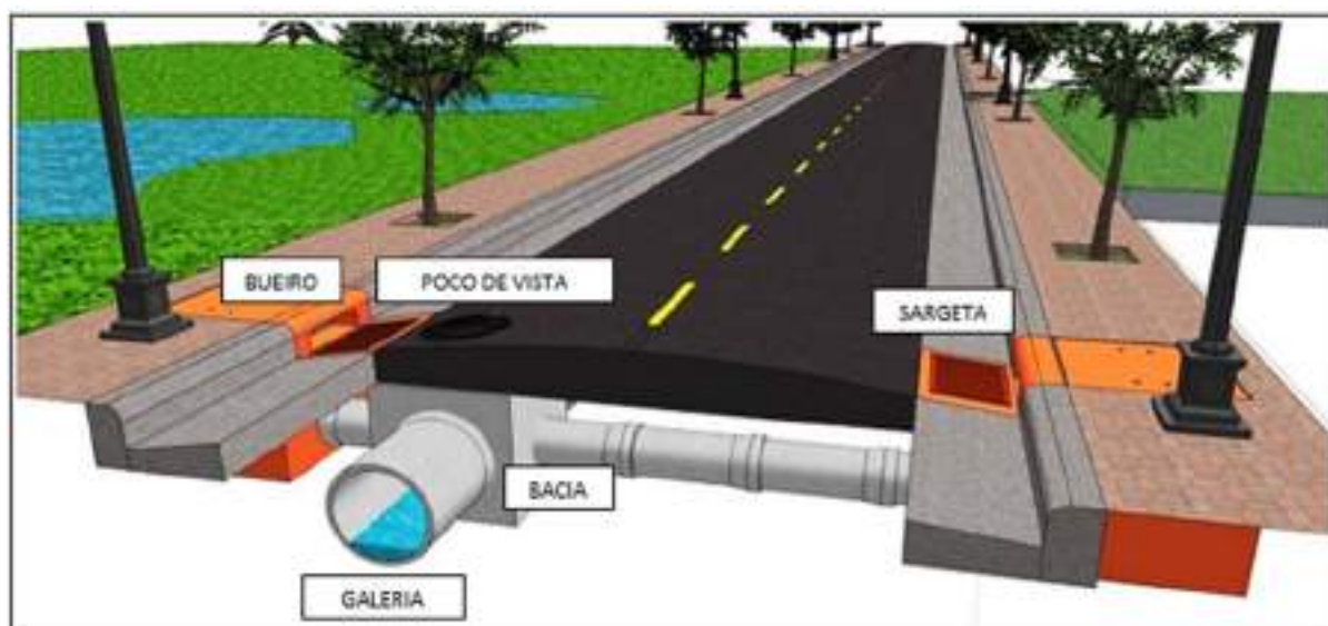
Figura 28 – Componentes de microdrenagem
