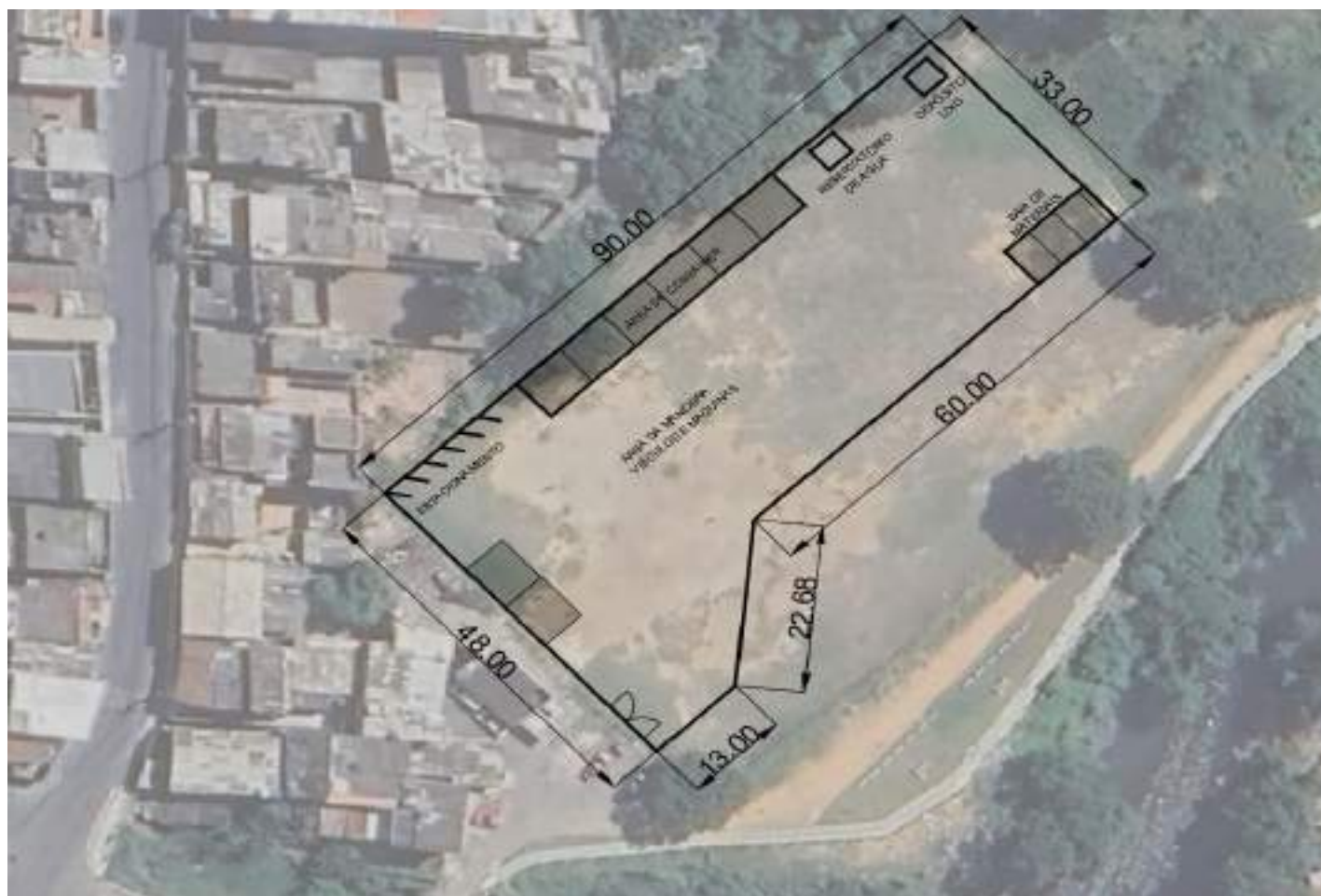
Figura 58: Layout do canteiro de obras.
